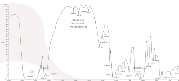
Figura 6: Espectro IR correspondiente a la reacción R_2
