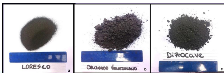
Figura 6. (a) Coque de petróleo importado Loresco (L); (b) Coque de petróleo venezolano calcinado en las instalaciones de CVG Carbonorca (PAC) y (c) Coque comercializado en Venezuela como material de relleno o Backfill suministrado por la empresa DIPROCAVE.
