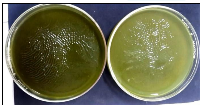
Figura 9: Simulador de tejido vegetal sano (der.) y con estrés hídrico (izq.), disolución en caliente
