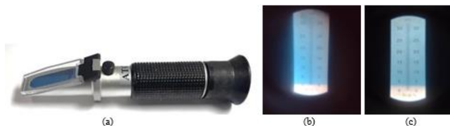
Figura 1.- a) Equipo utilizado para la determinación de grados Brix. b) Refractómetro calibrado con agua destilada. c) Medición de grados brix a la bebida con el refractómetro.
